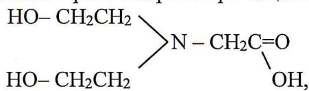
который, являясь аминокислотой, очень сильно увеличивает коррозионную активность рабочего раствора, в частности, за счет предотвращения формирования защитного слоя  $FeS$  на углеродистой стали.
